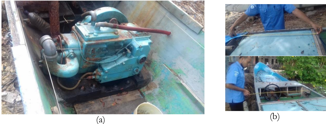
Gambar 9. (a) Ruang mesin perahu body tuna, dan (b) Pengukuran ruang mesin
