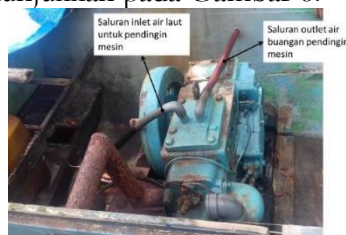
Gambar 6. Konstruksi mesin diesel dengan saluran sistem pendingin
